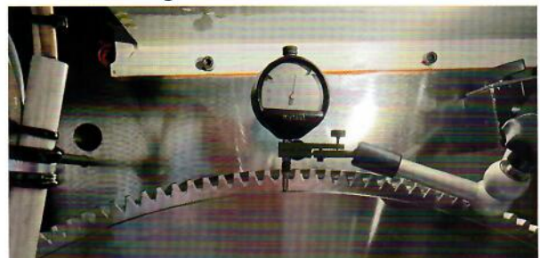
Bild 1: Vermessung des Rundlaufs am Zahnrad des Gegendruckzylinders
